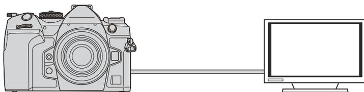
Sie können auch Videos aufnehmen, während die Kamera über HDMI an einen externen Monitor oder Videorecorder angeschlossen ist.
