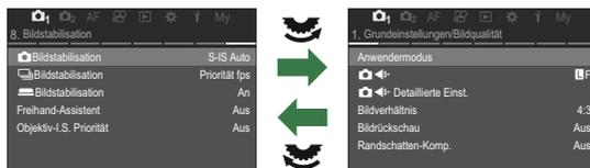
☺ Die Einstellung wird nur bei Bedienung über das hintere Einstellrad wirksam. Wenn Sie zum Wechseln zwischen Seiten die Pfeiltasten <|> verwenden, erfolgt die Navigation immer der Vorgehensweise bei Auswahl von **[Nein]** entsprechend.
