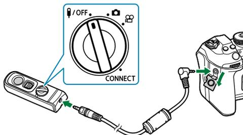
Drehen Sie das Modus-Einstellrad der Fernbedienung auf **OFF** und schließen Sie die Fernbedienung über das mitgelieferte Kabel an die Kamera an.
