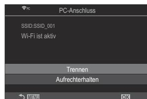
2. Markieren Sie mit den Pfeiltasten  $\Delta$   $\nabla$  die Option **[Trennen]** und drücken Sie die **OK**-Taste.
