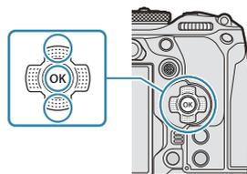
5. Markieren Sie die gewünschte Sprache mit den Pfeiltasten  $\Delta$   $\nabla$   $\triangleleft$   $\triangleright$  und drücken Sie die **OK**-Taste.
