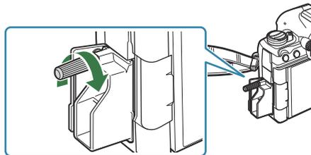
**3.** Bringen Sie den Kabelclip am Kabel und anschließend am Trageriemen an.
