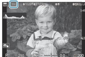
Wechselt die Einblendung auf [00] (rot), kann die Kamera das folgende Bild nicht mehr speichern. Werden die Bilder im Pufferspeicher auf die Karte geschrieben, steigt die eingeblendete Anzahl und die Kamera kann wieder Bilder speichern.
