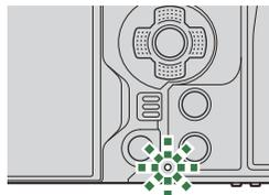
ⓘ Tritt beim Laden ein Fehler auf, blinkt die Akkuladeanzeige. Trennen Sie das USB-Kabel und schließen Sie es erneut an.
