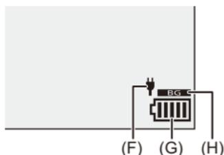
(F) Energieversorgung durch USB-Anschlusskabel
