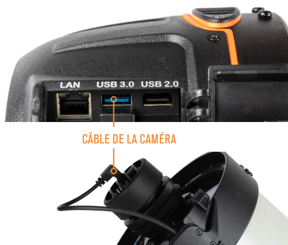
Fig 36 Une extrémité du câble de la caméra se branche sur la caméra. L'autre extrémité se branche sur l'un des ports USB d'Origin.
