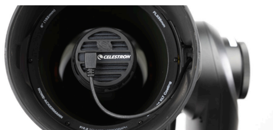
ABB. 29: Der im Werk aufgenommene und auf Origin vorgeladene Flat-Frame wurde mit der Kamera in der gezeigten Ausrichtung aufgenommen. Wenn Sie die Kamera aus dieser Ausrichtung herausdrehen, müssen Sie einen neuen Flat-Frame erstellen.
