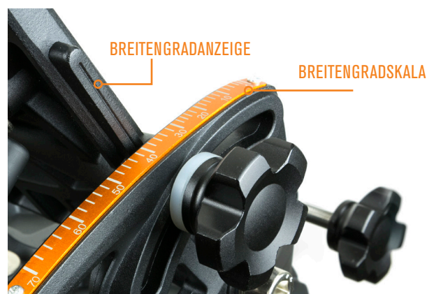
Abb. D2: Drehen Sie den Breitengrad-Einstellknopf am Äquatorialkeil, bis die Breitengradanzeige mit dem Breitengrad Ihres aktuellen Standortes auf der Skala übereinstimmt.
