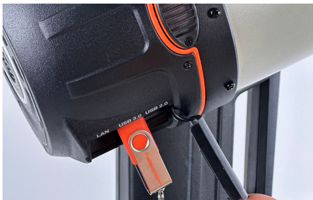
Fig 27 Insérez une clé USB dans le port USB du tube Origin pour transférer les fichiers d'image brute.
