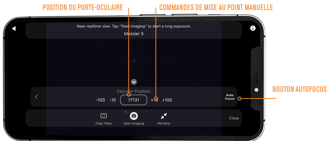
Fig. 12: Utilisez l'icône de mise au point pour accéder aux commandes de mise au point automatique et de mise au point manuelle. La position du focuser peut également fournir des informations utiles.
