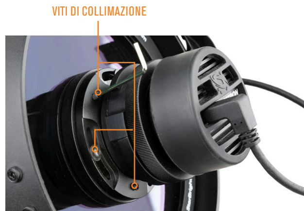
FIG. 34: Regolare l'inclinazione del gruppo lenti (e della fotocamera) con le viti di collimazione.
