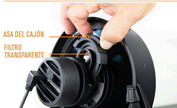
Fig. 15: Coja el asa del cajón con los dedos y tire hacia fuera para liberar el cajón de filtro de sus imanes.
