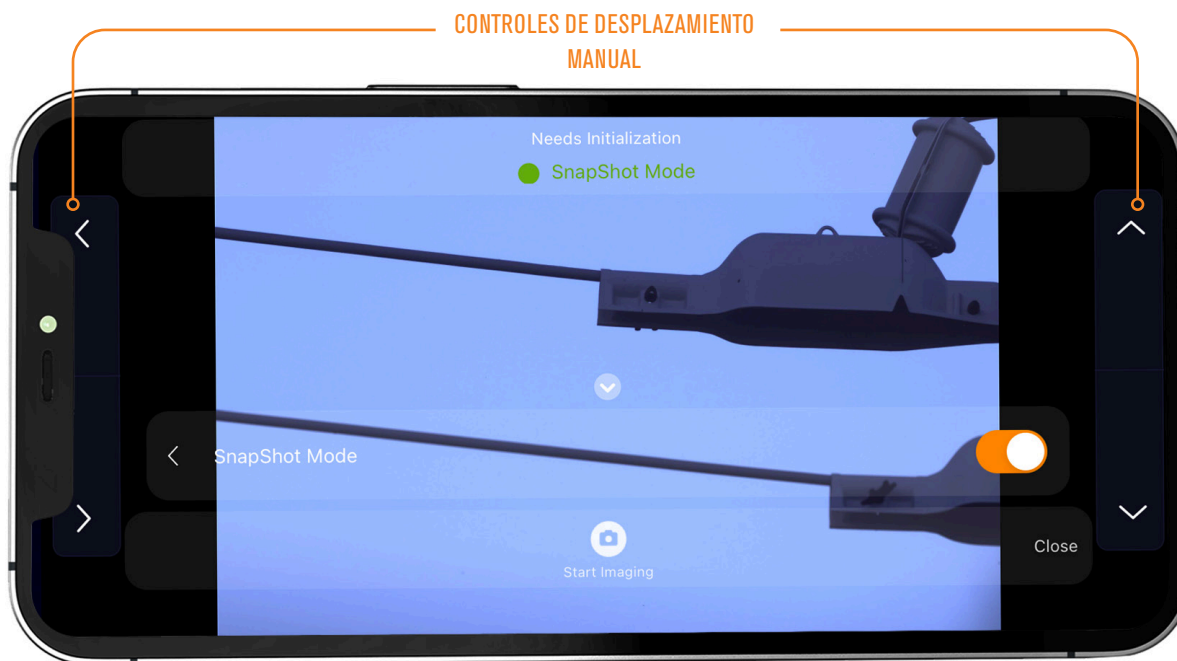
Fig. 23: Cuando esté en modo Instantánea deberá acceder a los controles de desplazamiento manual del telescopio en la Vista de cámara. Funcionan mejor con su dispositivo en modo paisaje.
