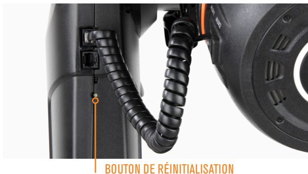
Fig 37 Dans de rares cas, vous devrez peut-être appuyer sur ce bouton renfoncé pour désactiver Origin
