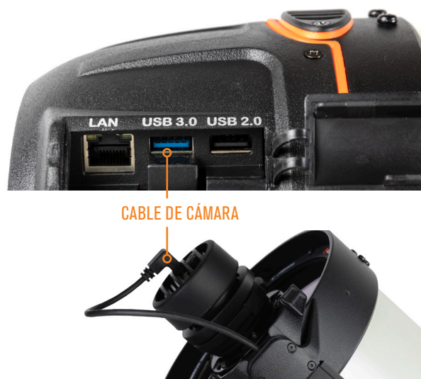
FIG 36: Un extremo del cable de la cámara se conecta con la cámara. El otro extremo se conecta a uno de los puertos USB de Origin.
