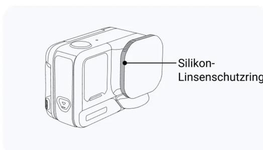
2. Schraube den Linsenschutz zum Abnehmen mithilfe des beiliegenden Schraubenschlüssels um 45° gegen den Uhrzeigersinn ab.
