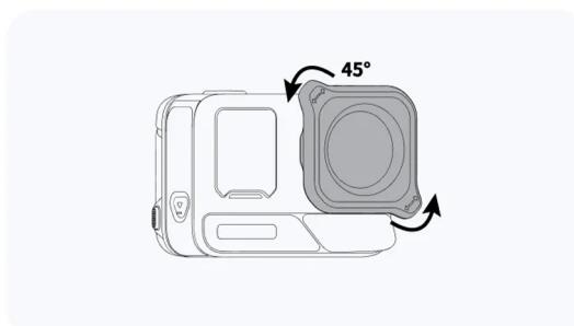
3. Setze das Makro-Objektiv auf und schraube es um 45° im Uhrzeigersinn fest.
