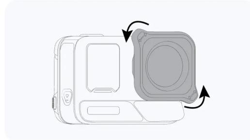
3. Setze das Ultraweitwinkel-Objektiv auf die Kamera und drehe es um 45° im Uhrzeigersinn, um es zu befestigen.
