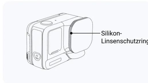
2. Schraube den Linsenschutz zum Abnehmen mithilfe des beiliegenden Schraubenschlüssels um 45° gegen den Uhrzeigersinn ab.
