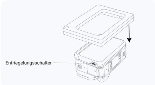
3. Ziehe die Schutzfolie vom doppelseitigen Klebeband auf der Rückseite der Flip-Touchscreen-Blende ab (②). Senke die Flip-Touchscreen-Blende langsam in Richtung des Ausrichtungswerkzeugs. Achte dabei darauf, dass sie in die richtige Richtung zeigt (③). Nimm das Ausrichtungswerkzeug weg, sobald die Blende richtig angebracht ist.
