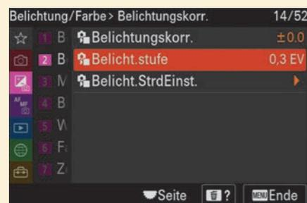
Abbildung 3.5 Die Schrittweite der Belichtungssteuerung können Sie von **0,3 EV** auf **0,5 EV** umstellen.
