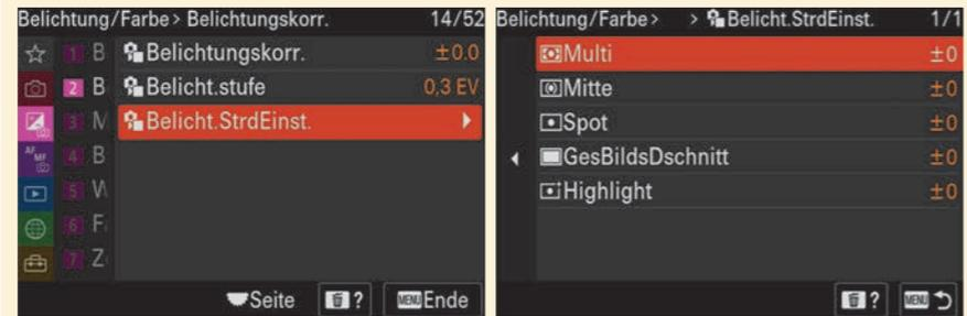
Abbildung 3.32 Zusätzlich zur normalen Belichtungskorrektur können Sie eine dauerhafte Korrektur der Belichtungsmessung vornehmen.
