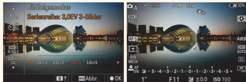
Abbildung 3.38 Einstellung einer Belichtungsreihe von drei Aufnahmen mit einer Schrittweite von drei Blendenstufen
